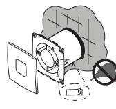
Rychlá instalace utažením svorek do jakéhokoli otvoru (pro modely A100XS / A120XS)
